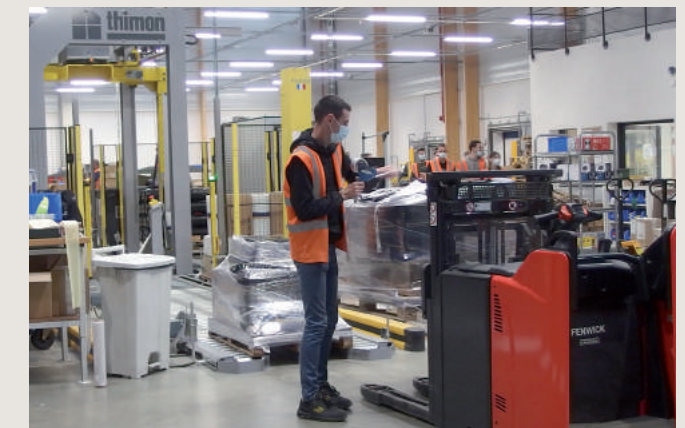
Der Stapler stellt die Palette in den Wartebereich und dann übernimmt der Packer. Dieses System beinhaltet eine doppelte Kontrolle der Bestellungen, wodurch die Zahl der Kundenreklamationen minimiert werden konnte. Die automatische Verpackungsmaschine ist in der Lage, 40 Paletten pro Stunde zu verpacken, die transparente Folie wird recycelt. Insgesamt bearbeitet die Versandabteilung täglich 250 Aufträge, von einem einfachen Briefumschlag mit einer Düse bis hin zu einem vollen Versandcontainer.
