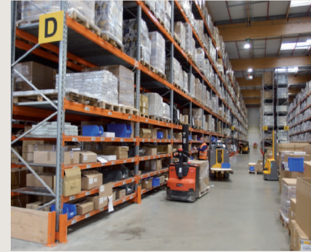
Das zweite Lagersystem bevorratet kleine Produkte mit hoher Umschlagshäufigkeit auf Regalen in den unteren Bereichen. Ein Barcode-Scanner zeigt den Standort jedes Teils und den einfachsten und schnellsten Weg zu seinem Standort an.
